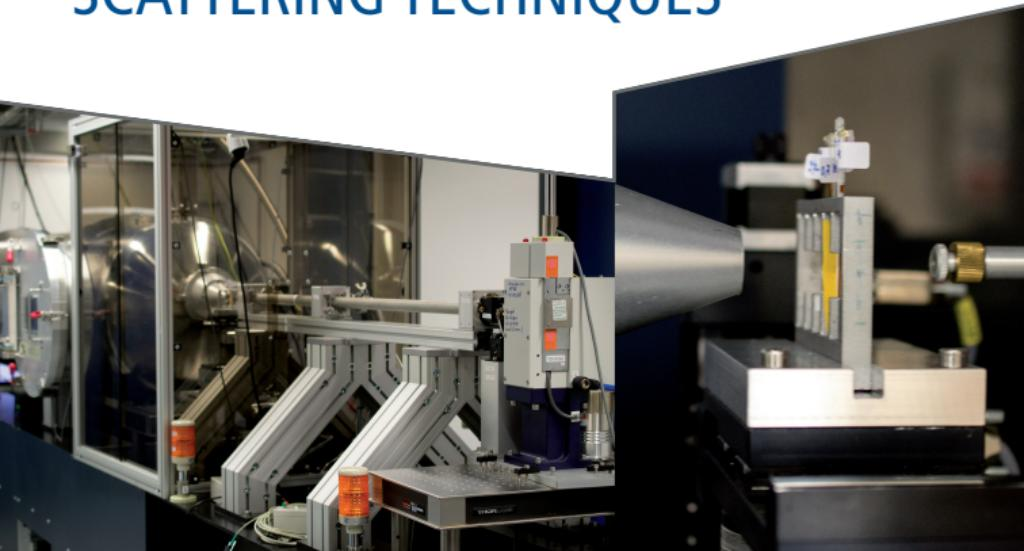
Das Keylab Scattering Techniques stellt moderne Instrumente für die Röntgenkleinwinkel- und Röntgenweitwinkel-Streuung (SAXS, WAXS) zur strukturellen Charakterisierung von Materialien auf Längenskalen von Angström bis zu mehreren hundert Nanometern zur Verfügung.
